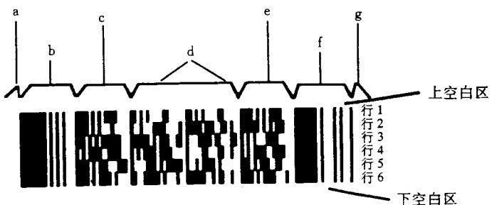
图 1 四一七条码符号的结构
