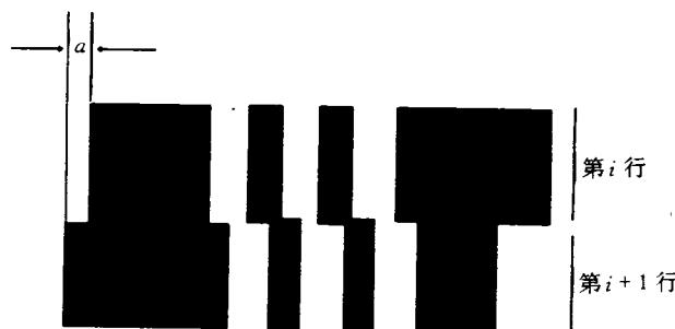
图 9 行间水平错位值测量
