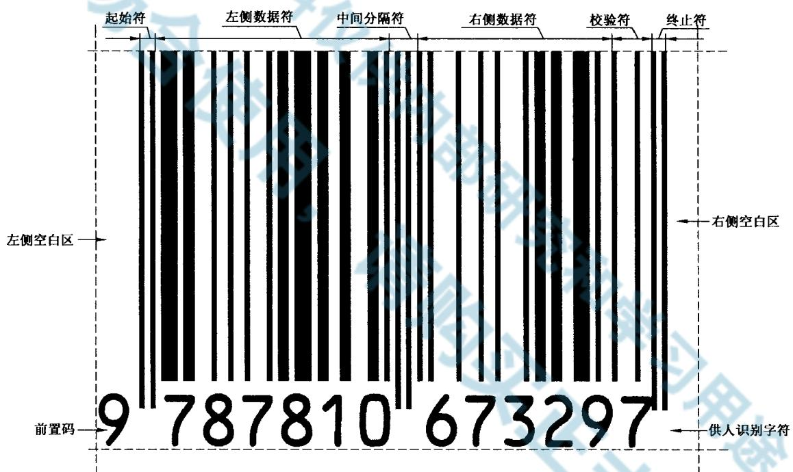
图 1 EAN-13 条码符号结构
